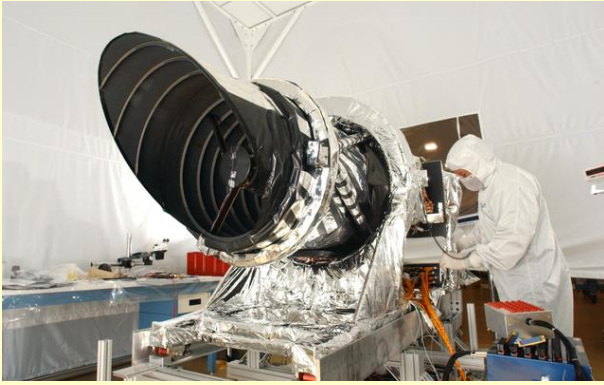
High Resolution Imaging Science Experiment (HiRISE) es uno de los 6 instrumentos de MRO de la NASA
