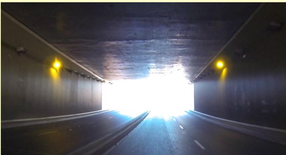
La iluminación de los túneles es un caso especial en el que se aumenta la cantidad de focos a la entrada y a la salida para reducir el deslumbramiento de los conductores. De día deberían encenderse la gran mayoría de los focos. De noche sólo se dejan encendidos unos pocos para igualar la iluminación a la del exterior. En la foto el tunel de la Avenida de Salamanca en Valladolid. Dispone de 78 focos en 110 metros de longitud de los que sólo se encienden 12, tanto de día como de noche.
