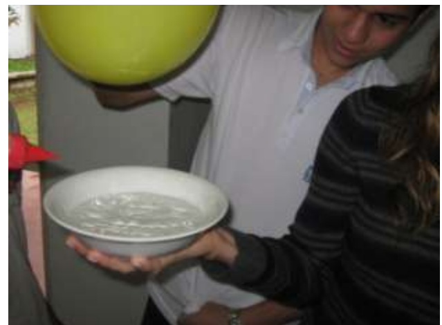
Figura 1, Agua en movimiento debido a la acción de fuerzas electrostáticas
