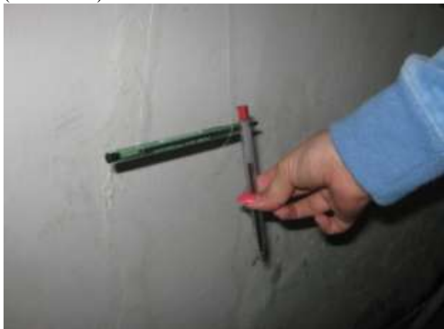
Figura 2, Lapicero giratorio debido a la acción de fuerzas electrostáticas
