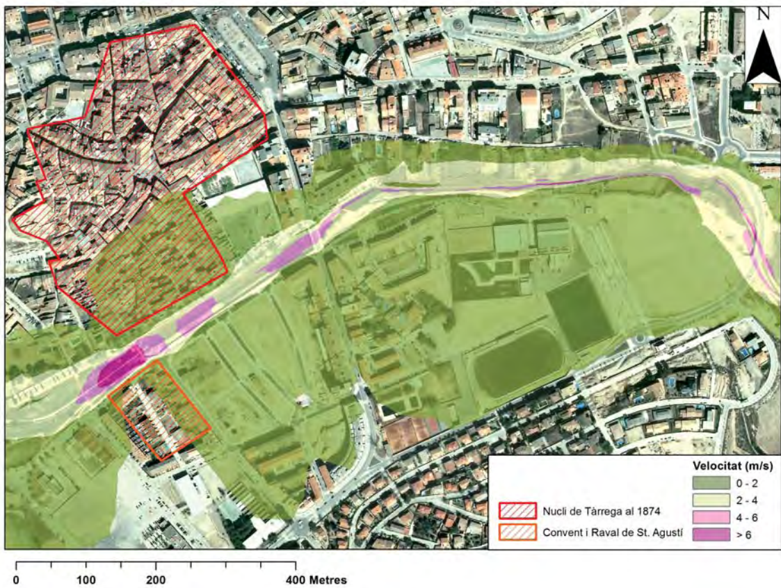
Figura 15. Velocitat de l'aigua en el moment del cabal pic. Font: elaboració pròpia.
