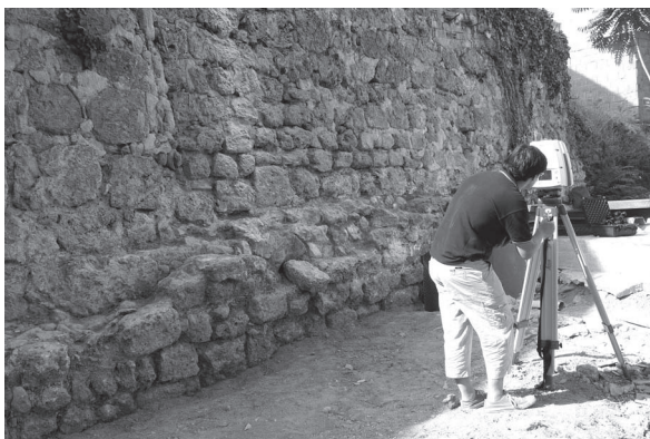
Fig. 43: Sector 5. Momento de la toma de datos con láser escáner para el levantamiento de este tramo de murallas.
