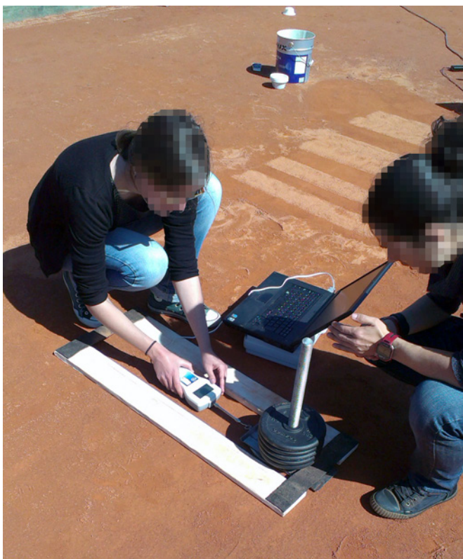
Figura 2. Equipo de medida de la interacción calzado-pavimento en desarrollo en el proyecto.
