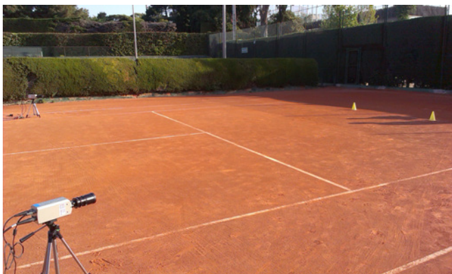
Figura 1. Colocación de las cámaras de alta velocidad para la realización de ensayos.
