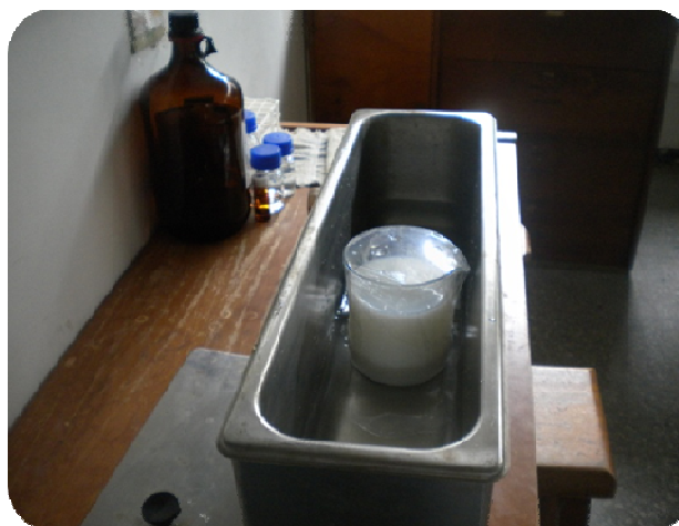
Figura 2. Montaje para suspensión coloidal de \text{TiO}_2 en ultrasonido.
