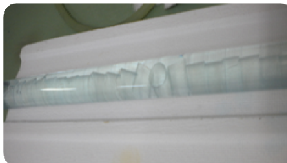
Figura 4. Empaquetamiento del tubo de reactor solar con el sustrato
