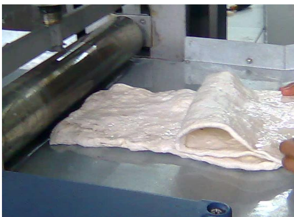
Figura 7. Proceso de laminado en el tren laminador.
