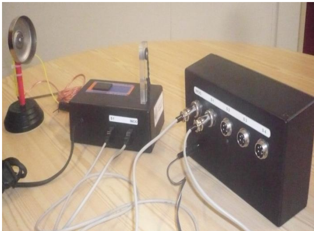
Figura 2. Cronómetro y dispositivo para la velocidad del sonido acoplados.
