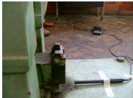
Figura 4. Montaje de micrófono para registrar presión sonora en función del tiempo durante el impacto.
