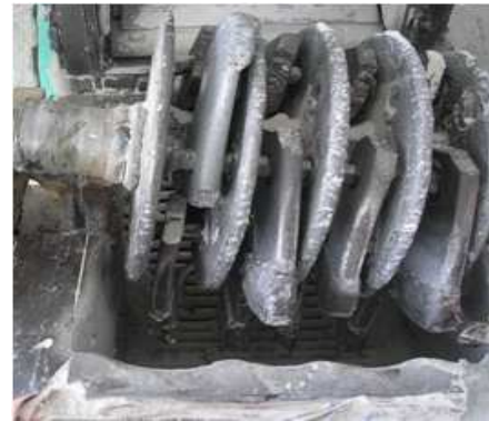
Figura 6. Vista frontal montaje de los martillos
