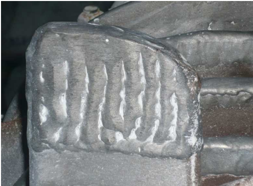
Figura 5. Martillo recubierto con West Hard 65
