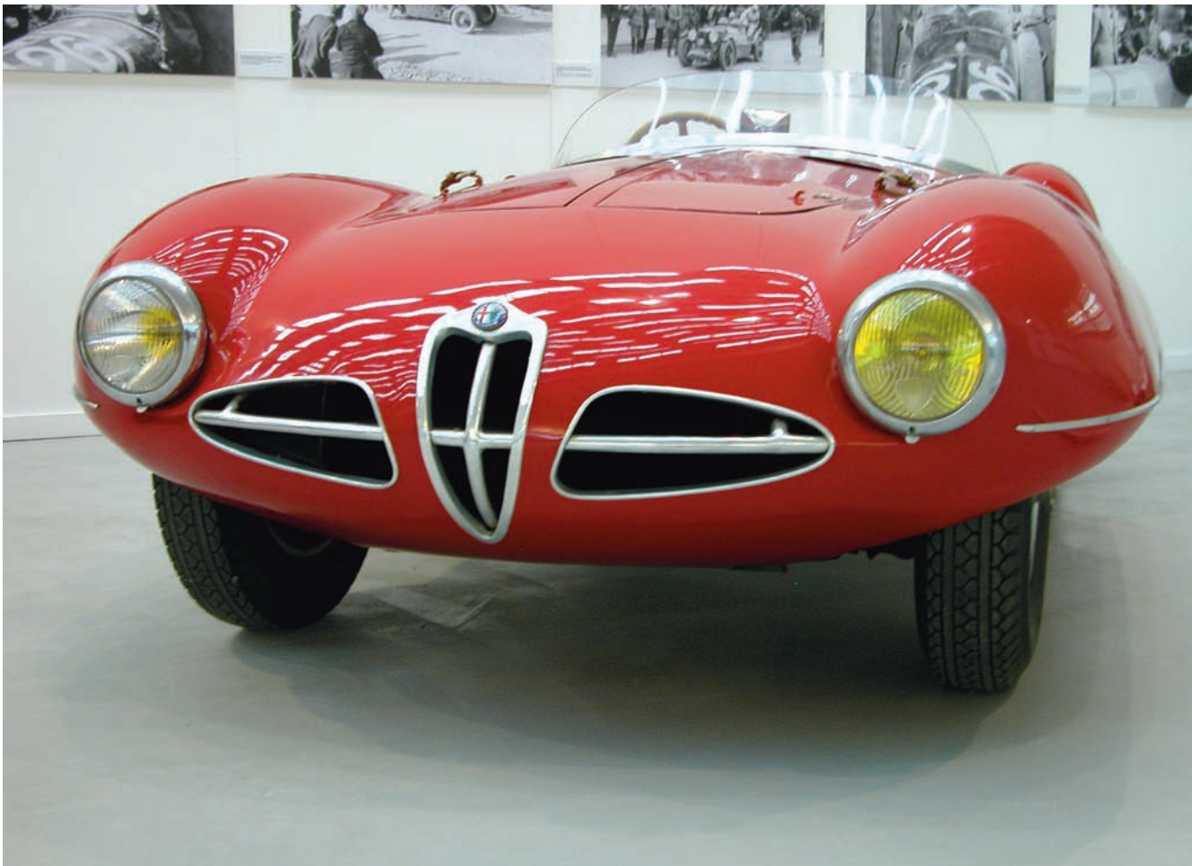
_Alfa Romeo Disco Volante, 1952, diseño Touring Milano, de perfil biconvexo y forma de ala de avión. Foto SGG
