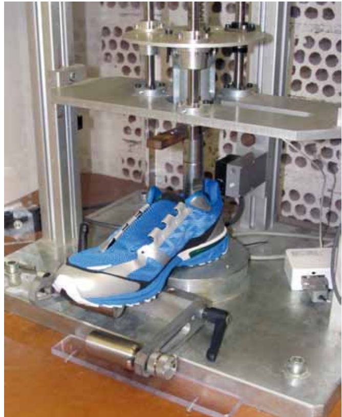
Figura 7. Ensayo de amortiguación de impactos con la máquina LecCus/IBV®.
