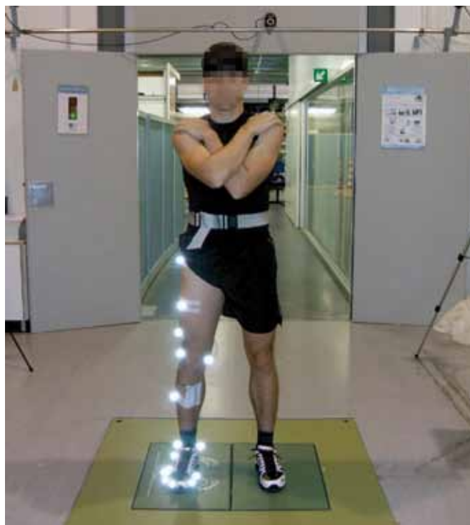
Figura 4. Corredor instrumentado durante el proceso de calibración.
