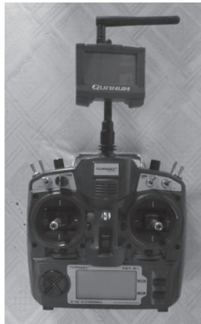
FIGURA 6. Mando por radiofrecuencia empleado para operar los actuadores del prototipo.
