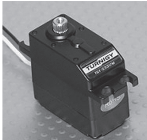
FIGURA 4. Servomotores empleados como actuadores para modificar la posición de los ejes en el prototipo en tierra.
