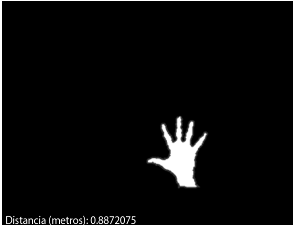
FIGURA 4. Detección del contorno utilizando la librería OPENCV.
