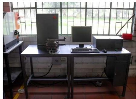
Figura 5. Mezcladora tipo Brabender
