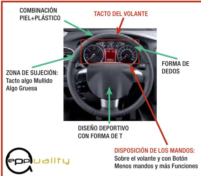
Figura 3. Ejemplo de criterios de diseño para volante de coche.
