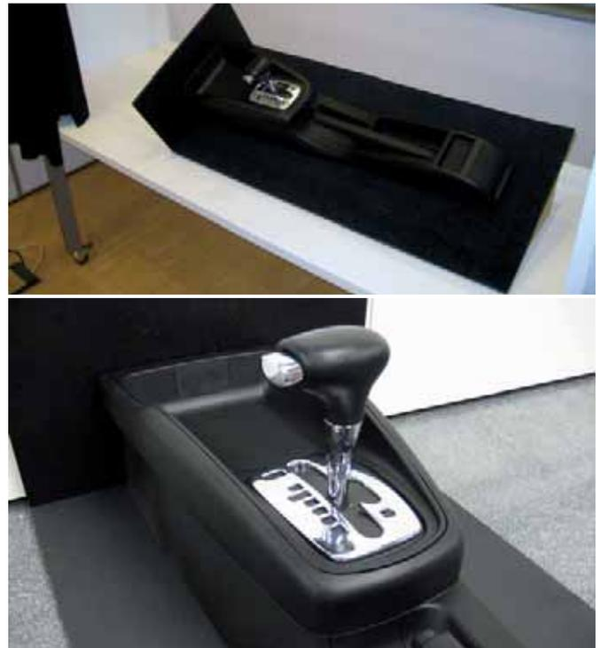
Figura 5. Maqueta realista del grupo de percepción túnel central.
