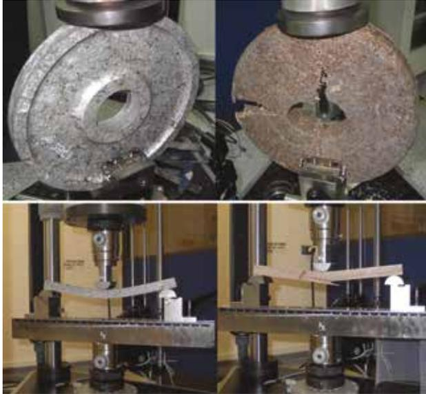
**Figura 5.** Pruebas mecánicas cualitativas de productos de LDPE-AL. Laboratorios de la Universidad Autónoma de Occidente, GITEM (2008)
