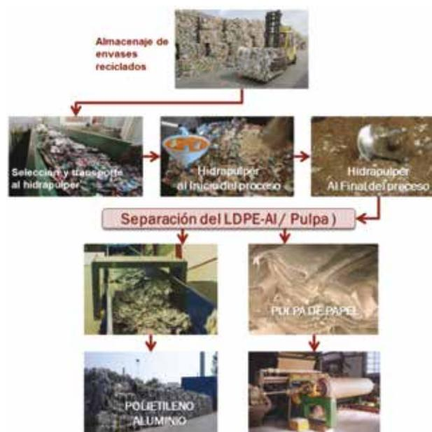
**Figura 2.** Proceso de separación mecánica por despulpado de envases reciclados multicapas.
