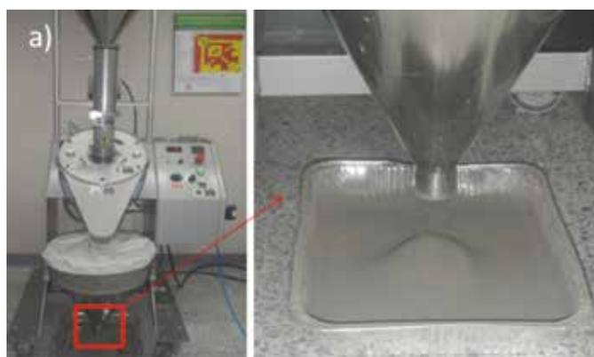
**Figura 9.** Proceso de pulverización del LDPE-Al: a) pulverizador criogénico con control de temperatura. Laboratorios de la Universidad Autónoma de Occidente, GITEM (2011)
