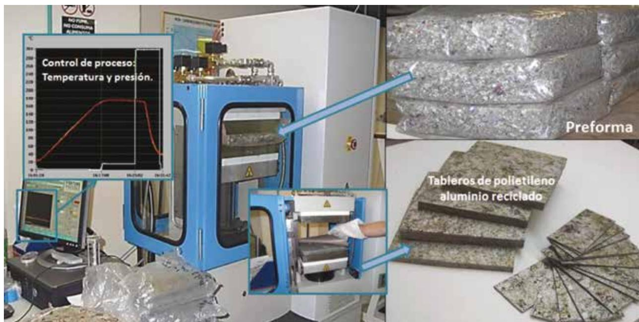
**Figura 3.** Proceso de moldeo por compresión del LDPE-Al. Laboratorios de la Universidad Autónoma de Occidente, GITEM (2007)
