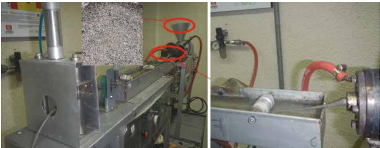
**Figura 6.** Proceso de extrusión del LDPE-AL. Laboratorios de la Universidad Autónoma de Occidente, GITEM (2009)
