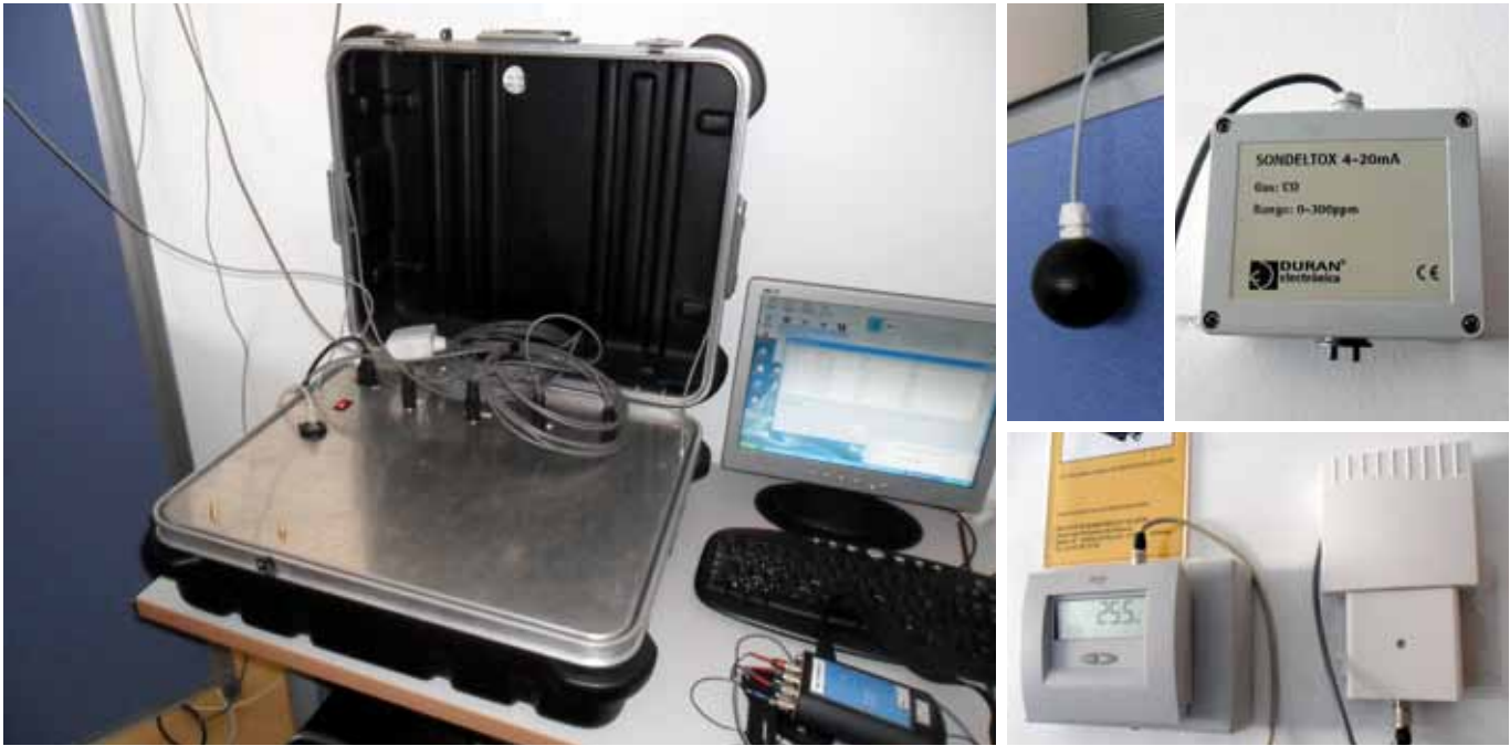
Figura 1. Prueba de concepto sistema de medida (sistema de control, sensor de temperatura radiante, sensor de CO, sensor de CO 2 , sensor de temperatura ambiental).
