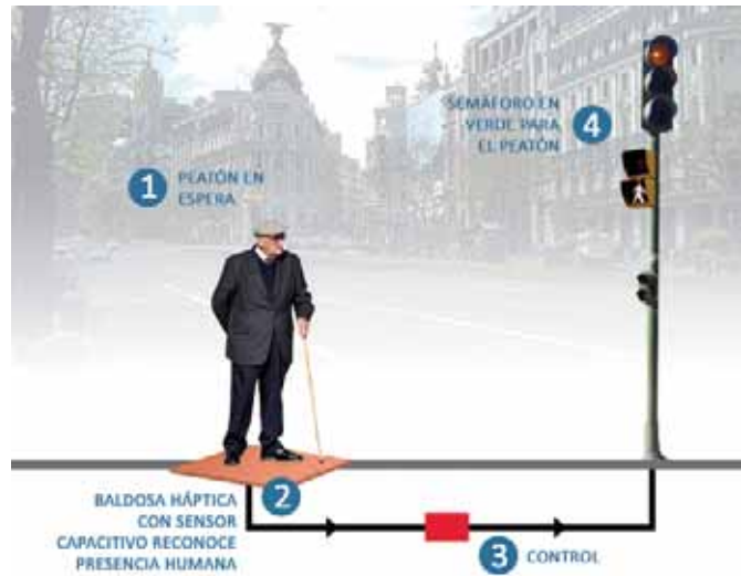
Figura 1. Esquema de funcionamiento, en 4 fases, del semáforo inteligente.
