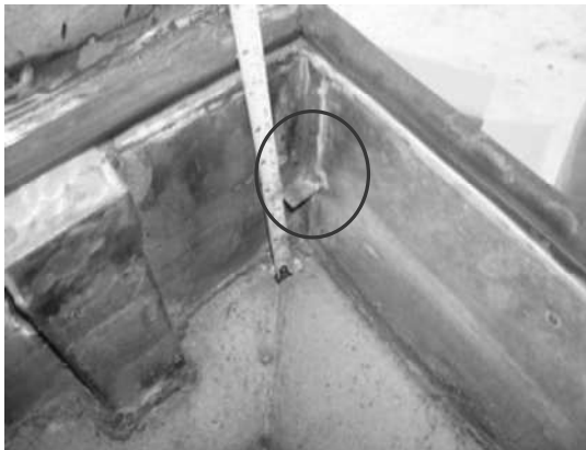
Figura 4. Recipiente de cloruro de metileno, los círculos muestran las pestañas de soporte de la rejilla
