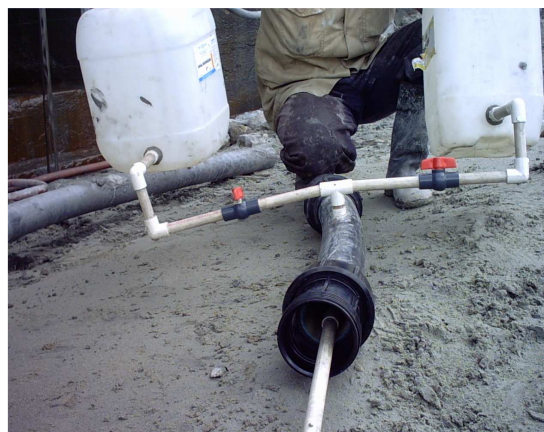
Figura 3. Montaje para la adición del Ácido de Caro
