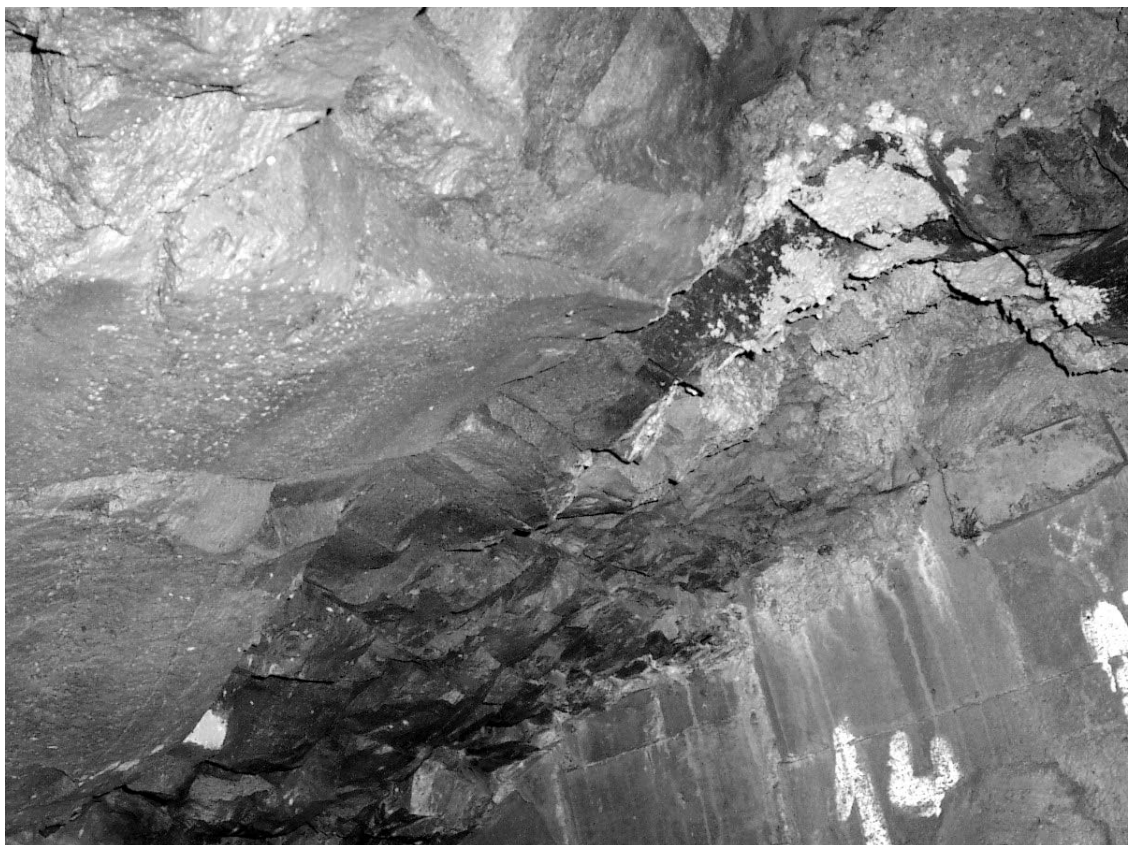
Figura 9. Cambio de formación geológica de basalto no alterado a dique dentro de la galería. (Fuente: Santamarta, J., 2005).
