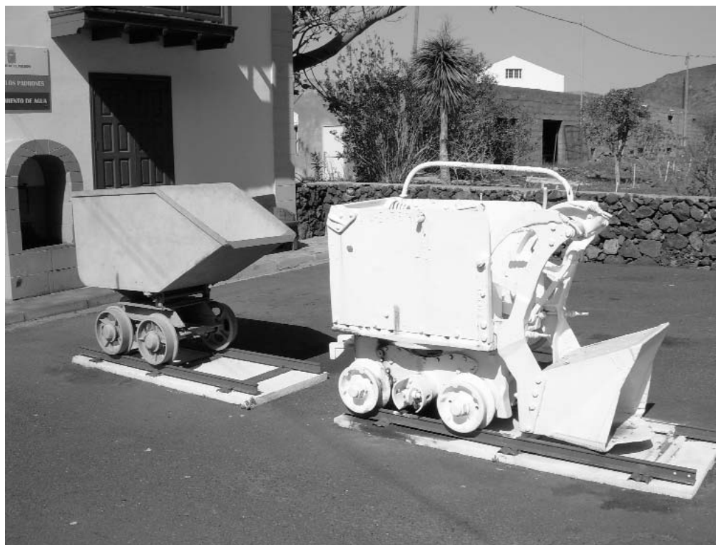
Figura 10. Maquinaria usada para la ejecución de galerías, maquina quita escombros y vagoneta. (Fuente: Santamarta, J., 2008).
