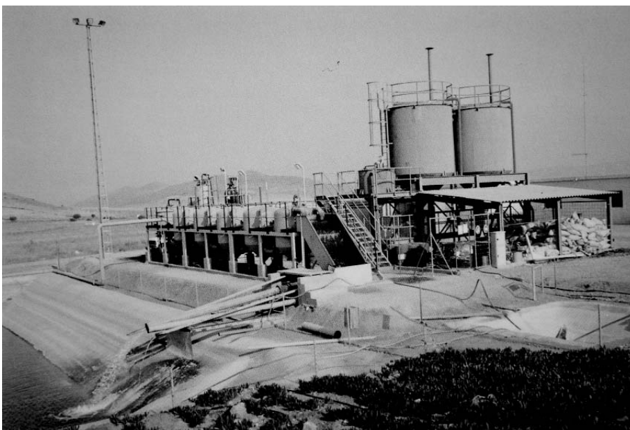
Figura 28. Canal que recogía el líquido enriquecido en oro.
