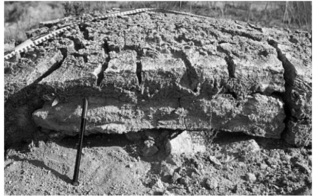
Figura 6. Alteración en los yesos por meteorización reciente en la superficie de la cantera.
