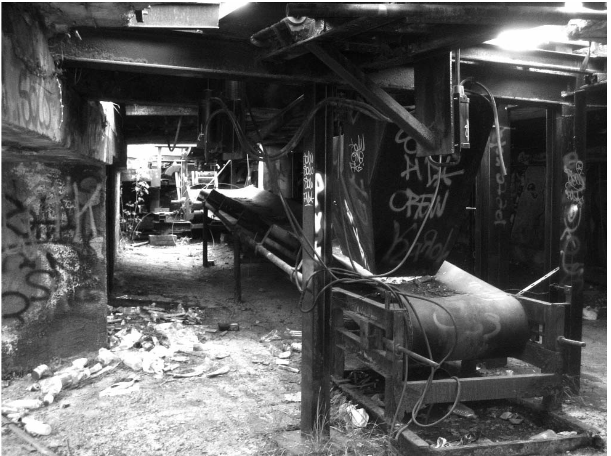
Figura 6. Estado en el que se encuentra la parte inferior cubierta del basculador, donde se acumulan los desperdicios.
