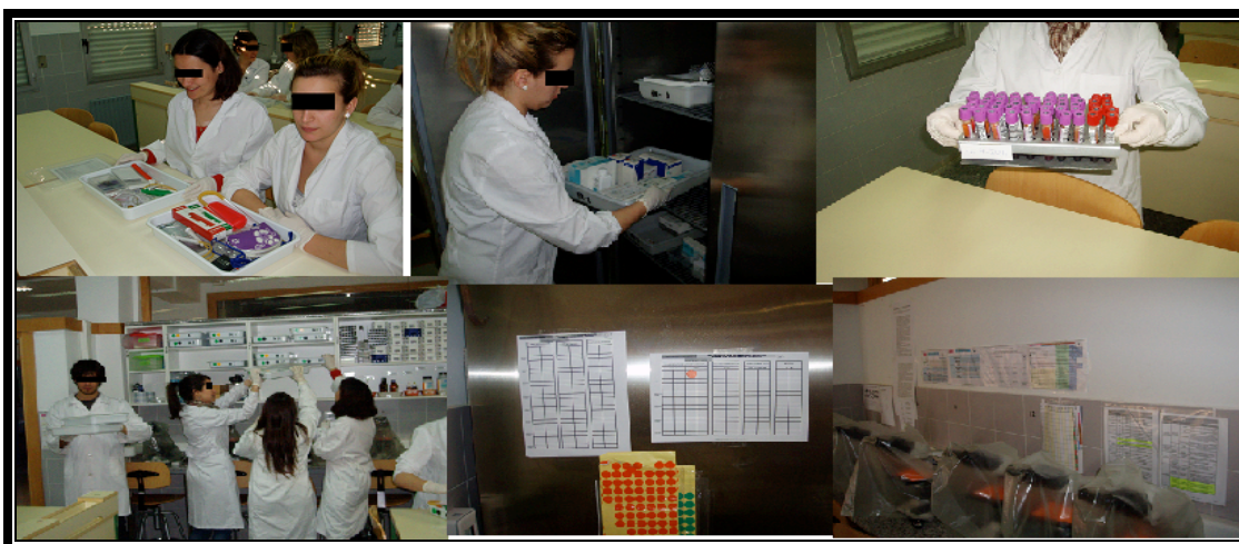
Figura II. Acceso y distribución ordenada del material al alumnado. Hojas de registro de incidencias y control visual después 5S
