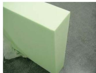
ESPUMA PU 30 kg/m<sup>3</sup>
