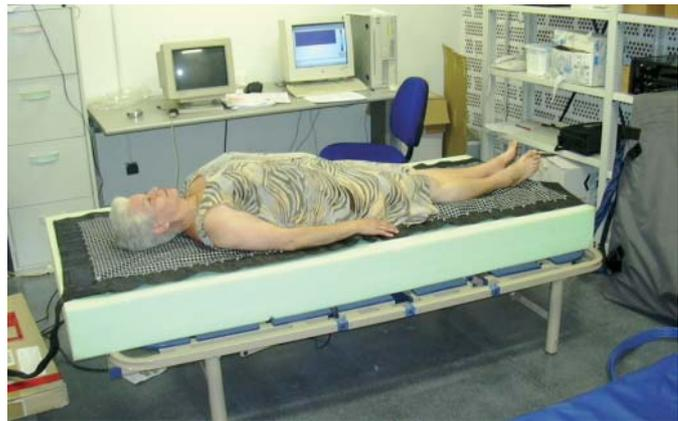
Figura 1. Un sujeto de ensayo realizando la prueba sobre el colchón de espuma de poliuretano.
