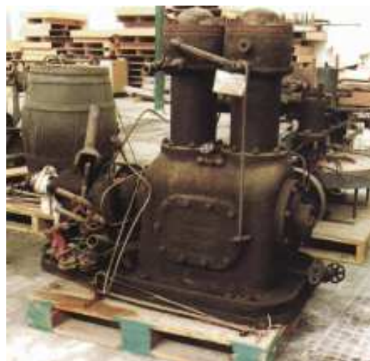
Foto 26. Màquina de fer gel marca JAVA model G de l'any 1924, fabricada a Barcelona. Fons Museu de la Ciència i la Tècnica de Terrassa (Perarnau, 1997).
