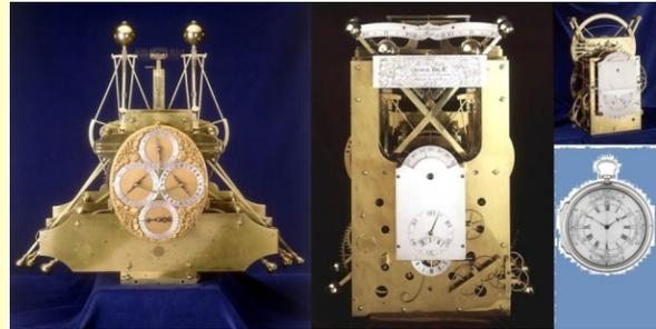
**Fig. 12** Prototipos creados por John Harrison para resolver el problema de la longitud geográfica en el mar. De izquierda a derecha: H1 (1736) y H2 (1741) regulados por péndulos de gravedad insensibles al balanceo de los barcos. H3 (1750) regulado por volante de inercia y espiral elástico recuperador. H4 (1760) morfológicamente parecido al anterior y miniaturizado, considerado como el primer cronómetro de marina de la historia. <http://www.youtube.com/watch?v=bcABUUIE-Zo>
