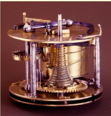
**Fig. 5** Maquinaria de un reloj inglés del S. XVII mostrando el complejo motriz barrilete-caracol. De la existencia de estos dispositivos deriva la frase popular "dar cuerda" a un reloj.
