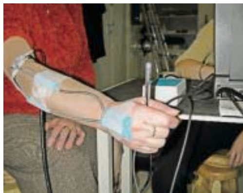
Figura 2. Ensayo en el que se determinan los rangos de movilidad de la muñeca.
