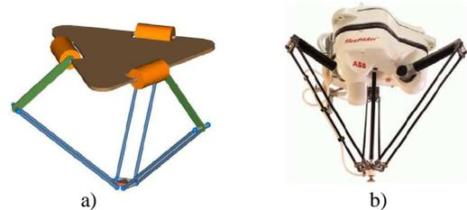
Fig. 6: Robot paralelo tipo Delta: a) Tres grados de libertad b) Cuatro grados de libertad [6].
