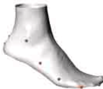
Figura 2: Adquisición de la forma del pie en 3D para una altura de tacón de 7 cm utilizando el escáner láser Polhemus Fastscan.
