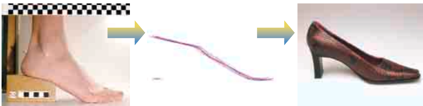
Figura 4: Esquema secuencial del estudio realizado en el proyecto: Adquisición de la curva del pie - análisis morfológico de las curvas - aplicación al diseño de calzado de tacón.
