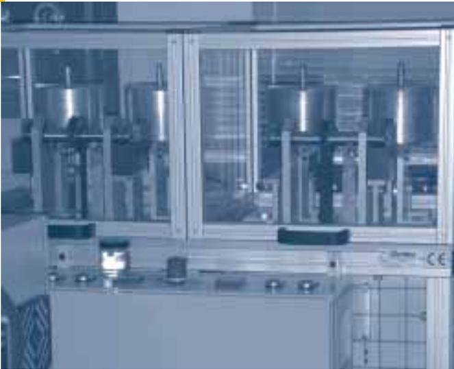
Figura 2. Máquina POC con sus cuatro estaciones.
