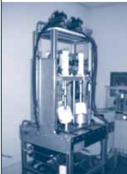
**Figura 5.** Simulador de desgaste de cadera.
