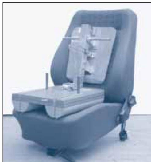
Figura 4. Asiento de automóvil con maniquí de carga.
