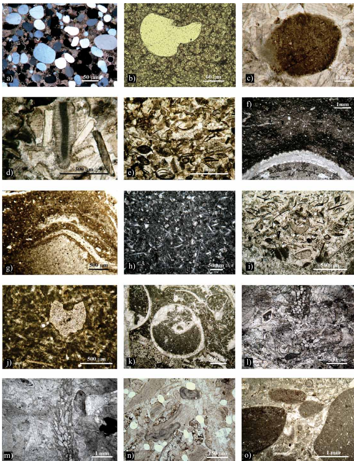
Figura 4. Fotomicrografías de secciones delgadas de las facies/microfacies de la Formación Pozo Nuevo, Cerro Salazar, Sonora central, a: Arenisca cuarcítica, MF1; b, c: Mosaico de dolomicroesparita romboidal y doloesparita con relicto de bioclasto de ostrácodo, MF2; d: Corte longitudinal de Nuia en cemento esparítico, MF3; e: Coquina de foraminíferos bentónicos en cemento de esparita, MF4; f: Valva de braquiópodo corrugado en micrita cryptoalgal, MF 5; g: Parte de un oncoide laminado, MF5; h: Wackestone con espículas de esponjas tipo monaxonas y tetraxonas, MF7; i: Wackestone a packstone crinoidal, MF8; j, k: Placa de equinodermo y gasterópodo en matriz peletoidal, MF9; l, m: Secciones longitudinal y transversal de una colonia de briozoarios, MF10; n: Artejos de crinoideos y Nuia en un mosaico de esparita, MF 11; o: Intraclasto micrítico bioclástico, MF12.
