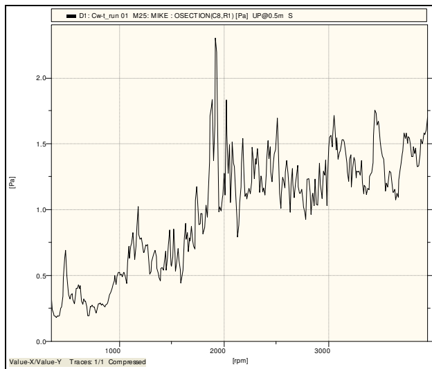
Figura 7. Evolución de la presión sonora medida en la reductora para el primer ciclo con notación CW-T.
