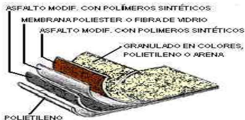
Figura 1.5 Mantos prefabricados. Fuente: [www.ciam.uco.mx](http://www.ciam.uco.mx)
