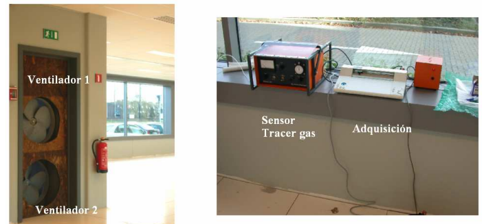
Figura 2. Detalles “blowing door” y sensor “Tracer gas”.
