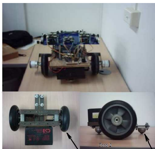
Foto 1 Vista Superior Estructura. Rueda de Tracción con Motor Vista Lateral Derecha E. Ruedas de Estabilización
