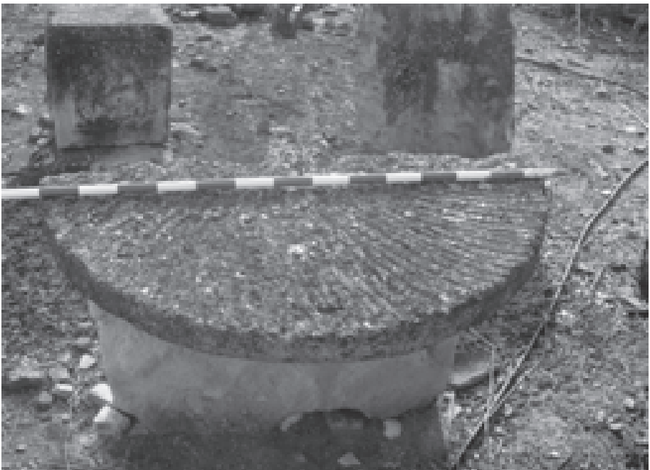
Lám. 6: Una de las piedras de moler instaladas en el molino de Don Francisco, emplazado en el río Monturque. (Foto: J. López)
