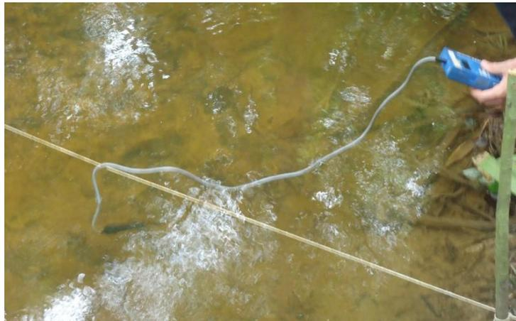
Figura 3 - Medição da condutividade elétrica.
