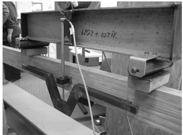
Figura No. 4 Ensayo de flexión para la viga laminada de sección tipo A.
