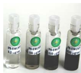
Figura 2. Nanotubos de carbono funcionalizados químicamente con ácido polisulfónico m-aminobenceno solubilizados en agua en concentraciones entre 0.62-620 \mu\text{g/mL} .
