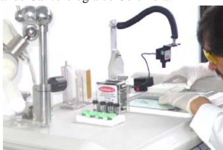
Figura 3. Sistema de radiación empleado para identificar la acción térmica de nanotubos de carbono en células tumorales 1595 y colo-255 .
