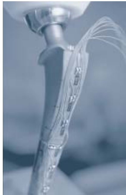
Figura 1. Vástago de cadera durante el ensayo con galgas extensométricas.
