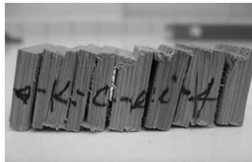
Figura No. 5 Probeta sometida a prueba de cizalladura.
