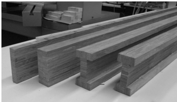
Figura No. 1 Latas de Guadua angustifolia Kunth unidas a través de cantos formando una viga
