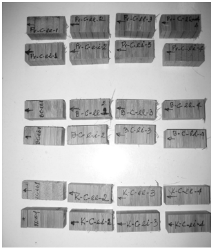
Figura No. 4. Identificación de probetas para cizalladura.
