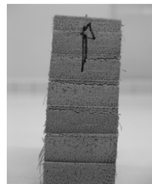
Figura No. 6 Probeta a cizalladura que muestra la falla de la unión por el material guadua.
