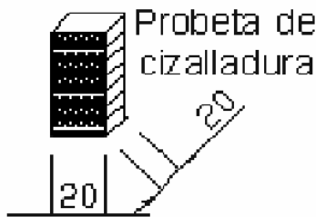
Figura No. 2 Probetas de cizalladura. Dimensiones en mm.
