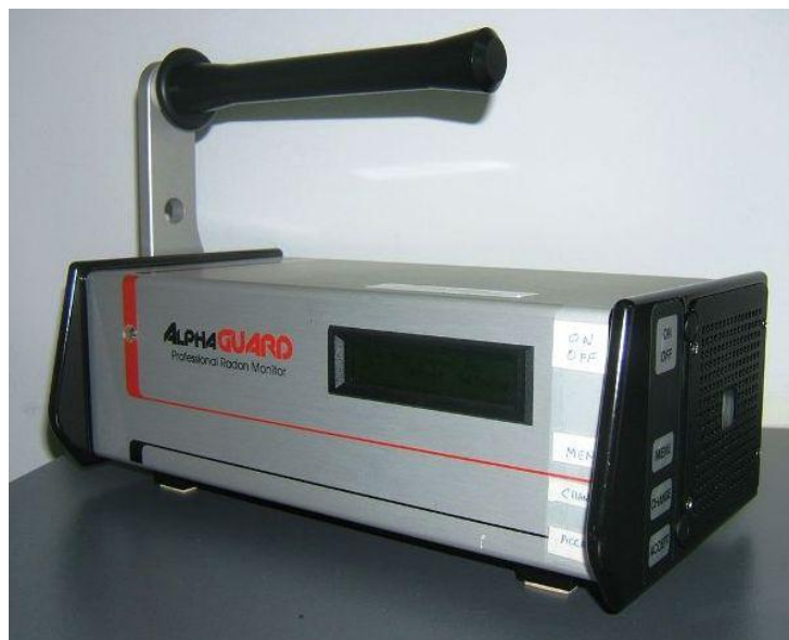
Figura 4. Detector para medir gas radón en continuo modelo “AlphaGUARD”.
