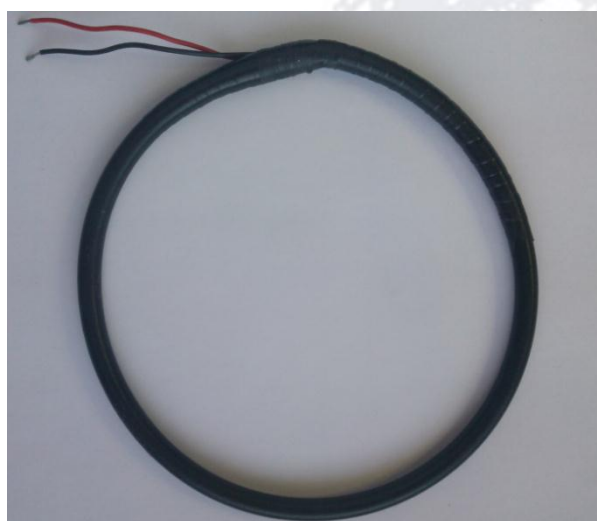
Figura 2. Bobina Rogowski construida en el laboratorio.
