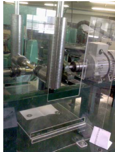
Figura 6. Máquina de Cilindro Cruzados diseñada y construida.
