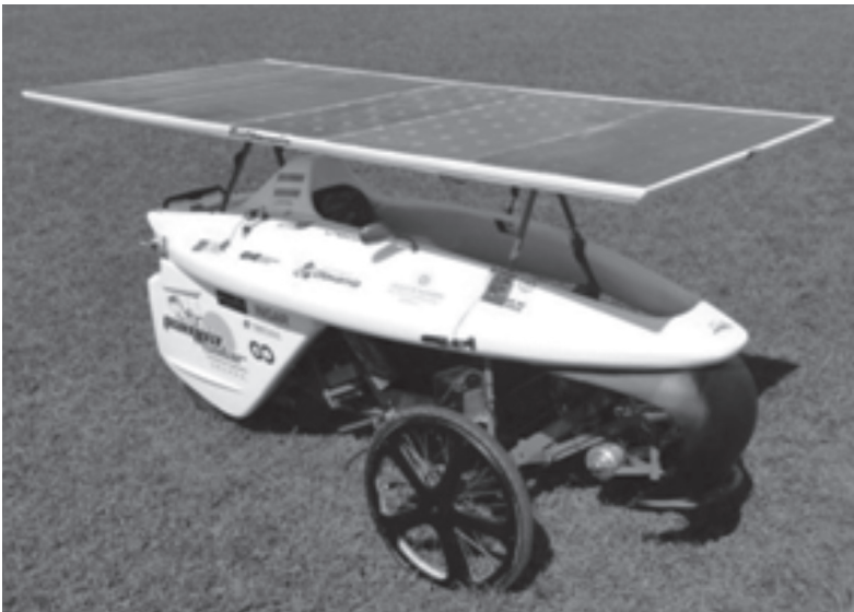
FIGURA 2. Versión final del vehículo, con paneles y carenado
